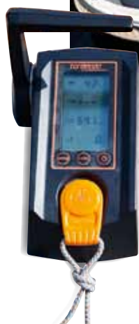
In der Steuereinheit des Torqeedo-Motors (l.) ist auch der Bordcomputer untergebracht
